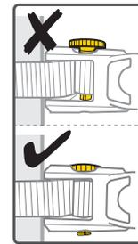
調整束帶至適安裝置後，將固定旋鈕向下壓。
